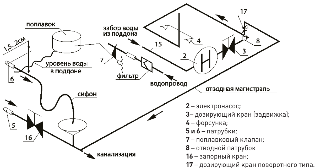
Рисунок 38. Принципиальная схема гидравлических соединений
