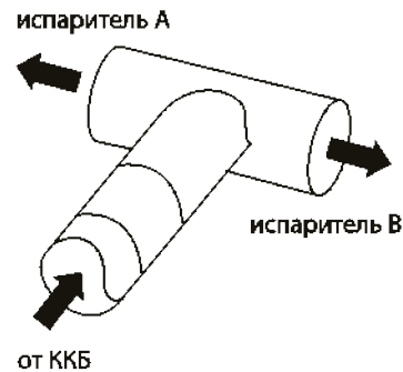
Рисунок 33. Подключение двух испарителей
